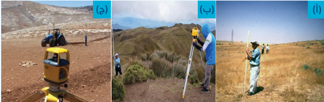
الشكل 17. تحديد خطوط الكنتور في الميدان: الأنبوب الشفاف (أ) جهاز المستوى؛ (ب) وجهاز التوجيه بالليزر؛ (ج) على جرار الفاليرياني
