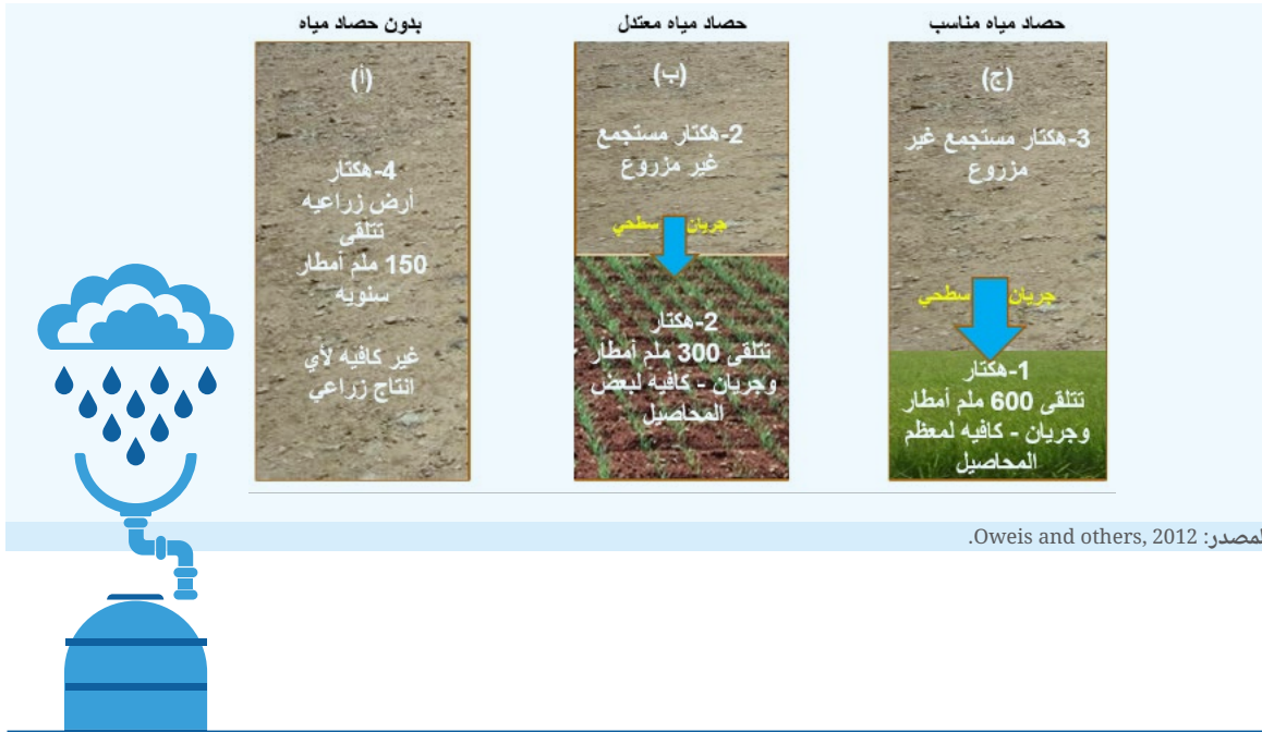
الشكل 1. رسم توضيحي لمفهوم حصاد مياه الأمطار لأغراض الزراعة: (أ) بدون حصاد مياه؛ (ب) مع تدخل معتدل؛ (ج) مع تدخل مناسب
